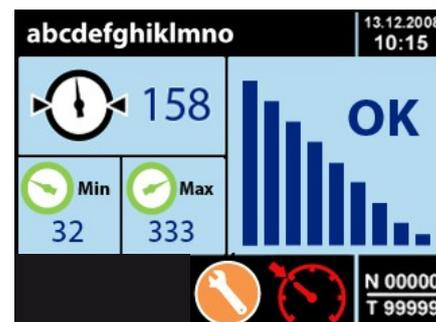
Определенное давление отображается цифрой и символом, который появляется в левом верхнем углу экрана:
