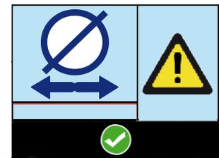
Этот экран предупреждения открывается при установке коррекции диаметра опрессовки больше или меньше, чем  $\pm 0.9$  мм/0.0354 дюйма (не допускается).
