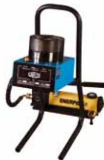
Мобильный пресс для изготовления рукавов высокого давления серии S1, несмотря на небольшие размеры и вес отличается повышенной надежностью и высоким качеством обжима. С помощью данного станка возможно изготавливать рукава высокого давления диаметром до 1".
