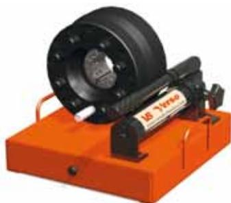
Ручной опрессовочный станок Verso VS25Mini предназначен для опрессовки рукавов высокого давления с внутренним диаметром до 1". Данная модель станка для опрессовки РВД характеризуется горизонтальным расположением опрессовочной головы, простым механизмом смены кулачков, удобной системой калибровки. Станок оборудован специальным ящиком для хранения кулачков.
