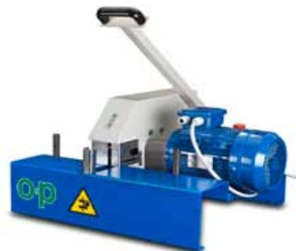
обращают на себя внимание простым, интересным, функциональным дизайном и являются упрощенными версиями станков TF1, TF2. Модели TF1/E, TF2/E - это недорогие, компактные машины для резки рукавов высокого давления, они способны отрезать шестиоплеточные рукава, TF1/E до 1", TF2/E до 1"1/2. Оба станка снабжены утапливаемым лезвием для безопасной работы оператора, а также всасывающим патрубком, для отвода продуктов горения. В ближайшее время данная продукция поступит на склад нашей компании.
