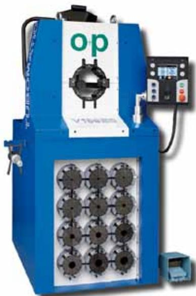
для обжатия предпрессованных фитингов и способен опрессовать 4-х оплеточные рукава до 1"1/4 и 2-х оплеточные рукава до 1". Станок
